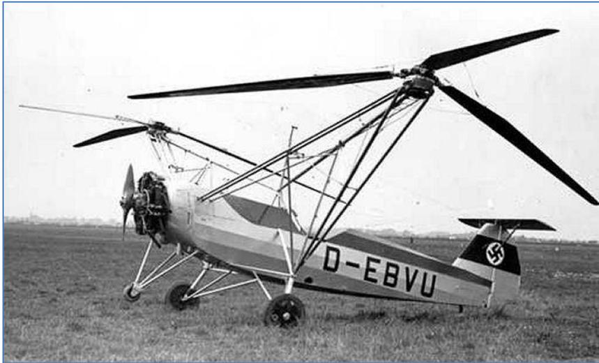
*Le Fw-61. La petite hélice à l'avant sert au refroidissement du moteur*
